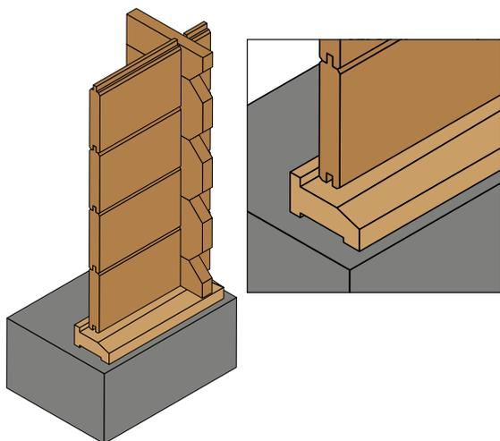
L'abri, construit en planches selon le principe du blockhut, est installé sur un cadre de fondation en bois exotique ou composite, lui-même reposant sur une chape en béton ou une terrasse déjà existante.
