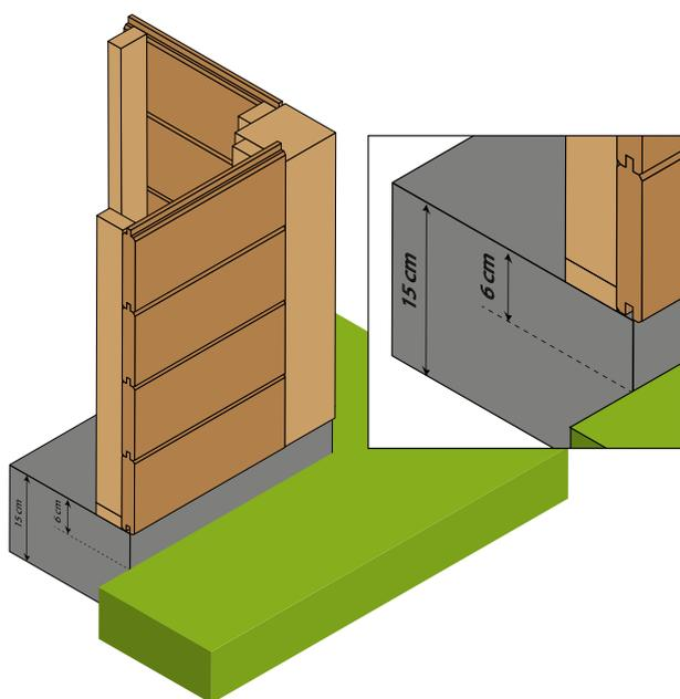
Les planches de l'abri sont fixées sur un cadre, lui-même solidement ancré à un poteau carré. L'ensemble (planches et poteau) est légèrement décalé vers l'extérieur, de quelques millimètres, par rapport à la chape de béton.
